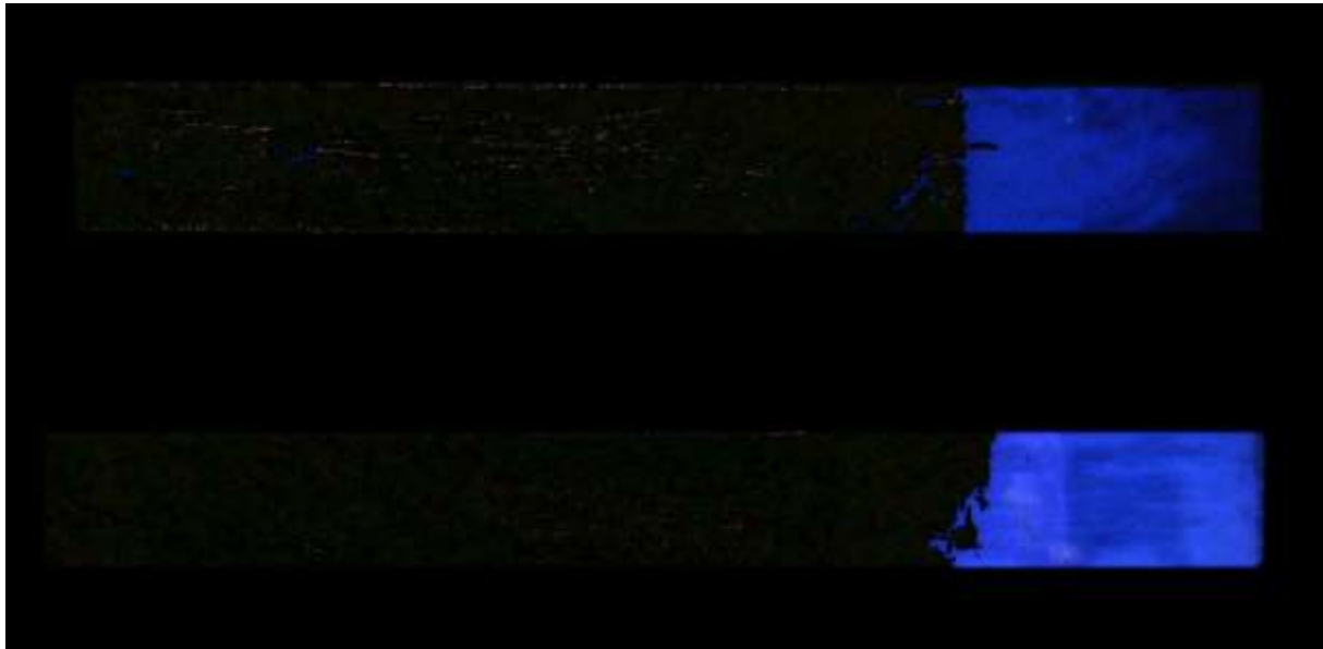
Échantillons d'ivoire recouvert d'une couche de vernis, puis de deux dorures à la mixtion superposées. L'échantillon de droite a subi un vieillissement artificiel. Imagerie CFV.
