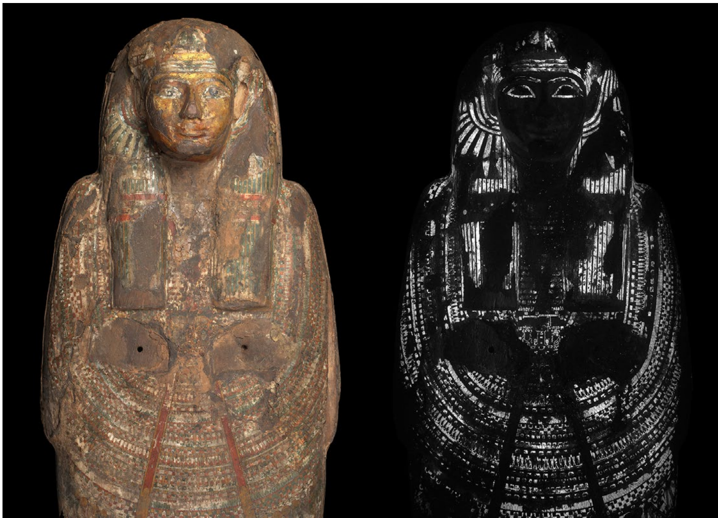
Fig. 4. Photographie visible (gauche) et photographie de la fluorescence sous lumière visible dans l'infrarouge (LIR) servant à repérer le pigment Bleu égyptien (en blanc). Cercueil de femme anonyme , musée du Louvre (Inv. E 18840). Image C2RMF/Anne Maigret.
