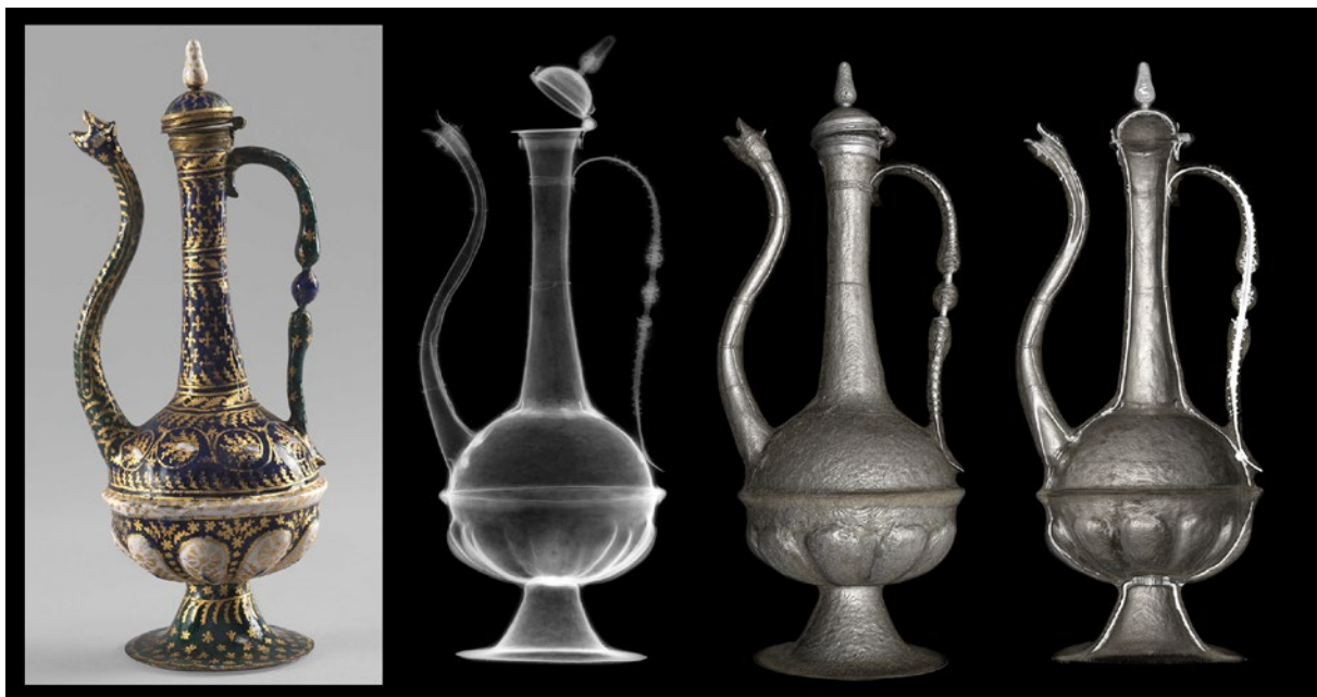
Fig. 9. Photographie de burette en structure métal et pâte de verre (gauche). La radiographie (centre gauche) montre la structure générale, alors que la tomographie permet de montrer précisément la surface du métal sous la pâte de verre (centre droit) et la surface intérieure de l'objet (droite). Burette vers 1480 , musée du Louvre (Inv. MR 2449). Images C2RMF/Anne Maigret (photographie) et Elsa Lambert (radiographie et tomographie).
